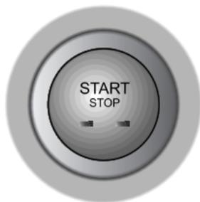
Der schlüssellose START/STOPP-Schalter befindet sich auf der Blendentafel rechts von der Lenksäule. Der Schalter hat die Form eines Druckknopfs. Der Schalter funktioniert nur, wenn sich der Smart Key im Fahrzeug befindet.
